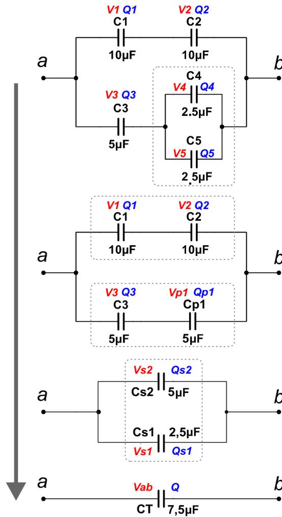
Figura 8: Esquema de simplificación del circuito.
