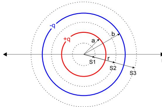
Figura 4: Superficies gaussianas utilizadas.
