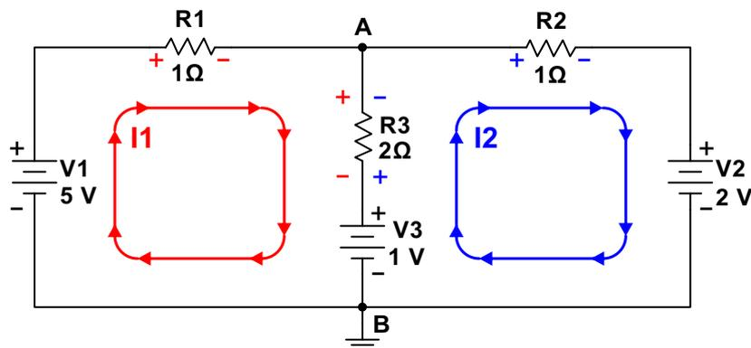
Figure 2: Corrientes de malla propuestas y caídas de potencial.
